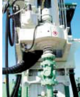
Testa di rotazione a 4 velocità. 4-speeds rotary head. Tête de rotation à 4 vitesses. 4-Geschwindigkeiten KDK. Cabeza de rotacion de 4 velocidades.
