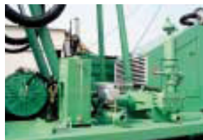
Pompa schiuma e lubrificatore. Foam pump and DTH hammer lubricator. Pompe a mousse et lubrificateur. Schaumpumpe und Oler für Imlochhammer. Bomba de espumante y lubricador en linea para martillo en fondo.
