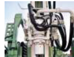
Testa di rotazione con mandrino per presa aste. Rotary head with drill pipes chuck. Tête de rotation avec mandrin pour tiges. KDK mit Bohrgestänge Spannkopf. Cabeza de rotacion con mordaza para tubería.
