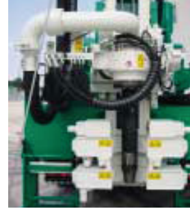
Testa di rotazione a 2 velocità. 2-speeds rotary head. Tête de rotation a 2 vitesses. 2-Geschwindigkeiten KDK. Cabeza de rotacion de 2 velocidades.
