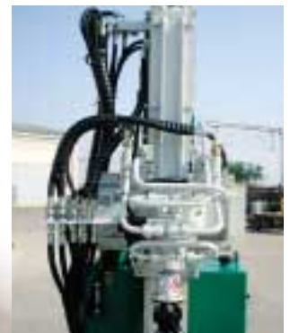
Testa per roto-percussione a 2 velocità. 2-speeds roto-percussion head. Tête pour roto-percussion à 2 vitesses. 2-Geschwindigkeiten KDK für Rotoperkussion (Schlaghammer). Cabeza de rotacion por rotopercusión de 2 velocidades.
