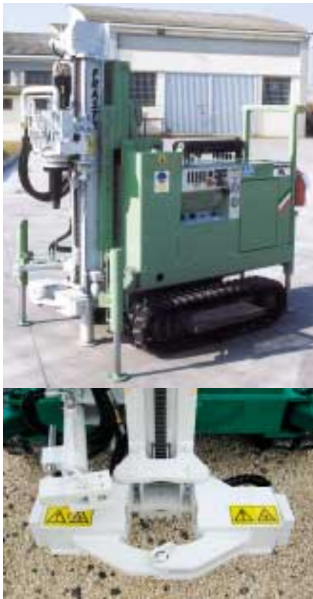
Morsa semplice e cilindro svita aste. Simple clamp with drill pipes breaking cylinder. Simple mors et vérin déblocage de tiges. Einfachabfangvorrichtung und hydr. Zylinder für Bohrgestänge aufschrauben. Mordaza simple y cilindro destornillamiento de barras.
