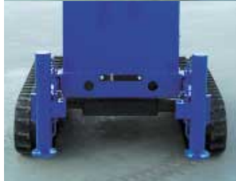
Carro cingolato a carreggiata variabile. Variable track crawler carrier. Chenille à voie variable. Raupefahrwerk - Breitenverstellbar. Carro oruga con carril variable.
