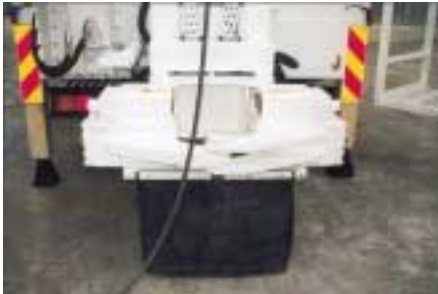
Morsa semplice, rulli guida aste e parapolvere. Simple clamp, hydraulic guide rollers and dust protection. Simple mors, rouleaux-guide hydrauliques des tiges et para-poudre. Einfachabfangvorrichtung, hydr.-Führungswalzen und Staubschutz. Mordaza simple, rodillos de guía hidráulicos y parapolvo.
