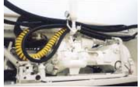
Pompa fango a pistoni. Piston mud pump. Pompe à boue a pistons. Kolben - Schlammpumpe. Bomba de lodos a pistones.
