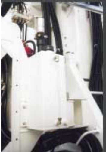
Lubrificatore per martello fondo foro. Down-the-hole hammer line lubricator. Lubrificateur pour marteau fond de trou. Öler für Imlochhammer. Lubricador en linea para martillo en fondo.
