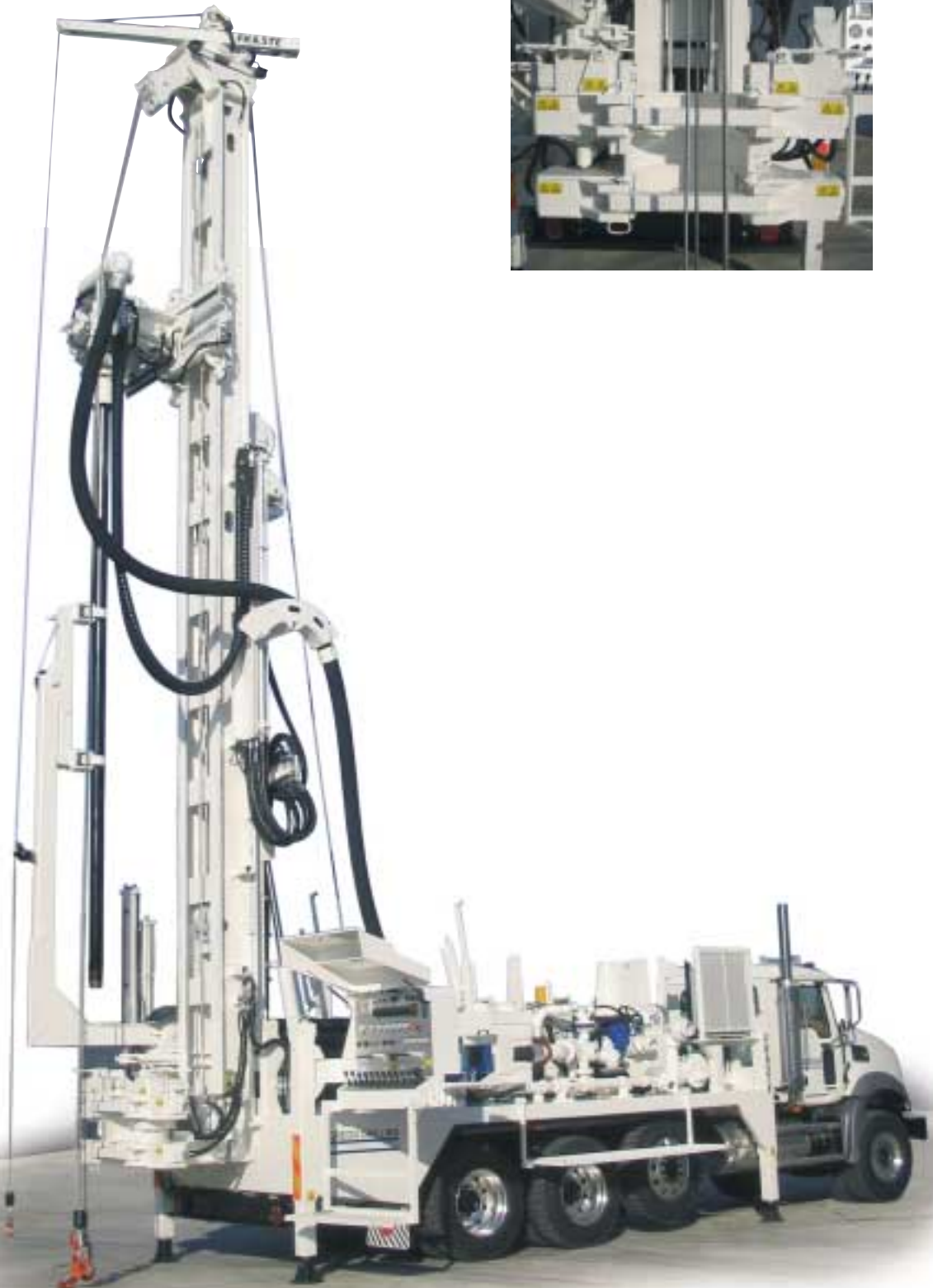
Pompa in aspirazione e collettore per circolazione diretta/inversa. Vacuum pump and manifold for direct/reverse circulation. Pompe en aspiration et collecteur air/boue pour circulation directe/inverse. Direktem/Indirektem Spülung Saugpumpe mit Luft/Schlammsammler. Bomba de aspiracion y colector para circulacion directa e inversa.
