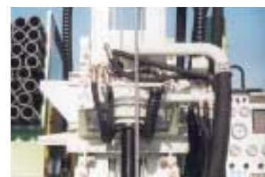
Testa di rotazione a 2 velocità. 2-speed rotary head. Tête de rotation a 2 vitesses. 2-Geschwindigkeiten KDK. Cabeza de rotacion de 2 velocidades.
