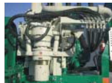
Testa di rotazione con mandrino per presa aste. Rotary head with drill pipes chuck. Tête de rotation avec mandrin pour tiges. KDK mit Bohrgestänge Spannkopf. Cabeza de rotacion con mordaza para tuberia.
