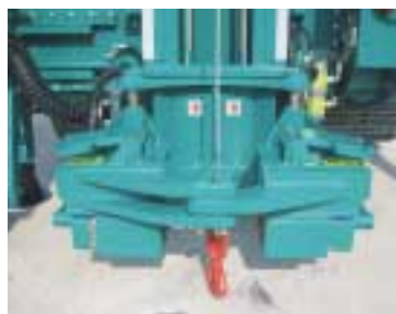
Morsa semplice, rulli di guida idraulici e portelli di sicurezza. Single drilling clamp, hydraulic guide rollers and safety doors. Morse simple, rouleaux-guide hydrauliques des tiges et porte de sécurité. Einfachabfangvorrichtung, hydr.-Führungswalzen und Sicherheitstüre. Mordaza simple, rodillos de guía hidráulicos y porte de seguridad.
