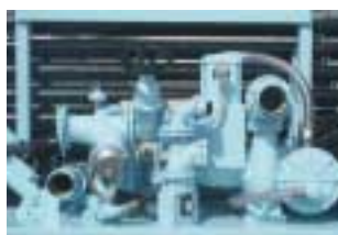
Pompa in aspirazione e collettore per circolazione diretta/inversa Vacuum pump and manifold for direct/reverse circulation. Pompe en aspiration et collecteur air/boue pour circulation directe/inverse. Directem/Indirektem Spülung Saugpumpe mit Luft/Schlammssammler. Bomba de aspiracion y colector para circulacion directa e inversa.
