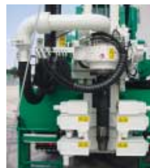
Testa di rotazione a 2 velocità. 2-speeds rotary head. Tête de rotation a 2 vitesses. 2-Geschwindigkeiten KDK. Cabeza de rotación de 2 velocidades.
