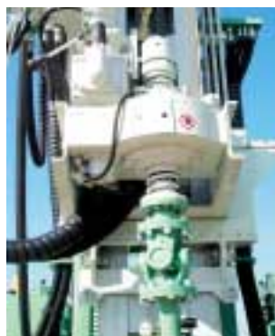
Testa di rotazione a 4 velocità. 4-speeds rotary head. Tête de rotation à 4 vitesses. 4-Geschwindigkeiten KDK. Cabeza de rotación de 4 velocidades.
