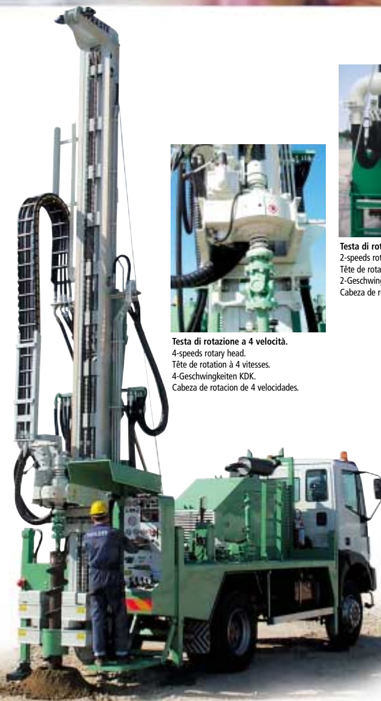
Testa di rotazione con mandrino per presa aste. Rotary head with drill pipes chuck. Tête de rotation avec mandrin pour tiges. KDK mit Bohrgestänge Spannkopf. Cabeza de rotación con mordaza para tubería.
